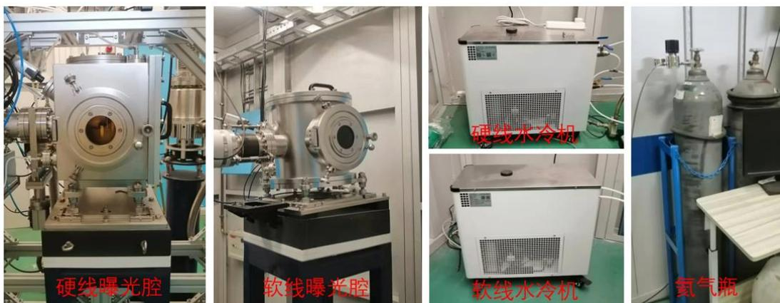
硬线曝光腔：用于硬线样品的放置及扫描。
