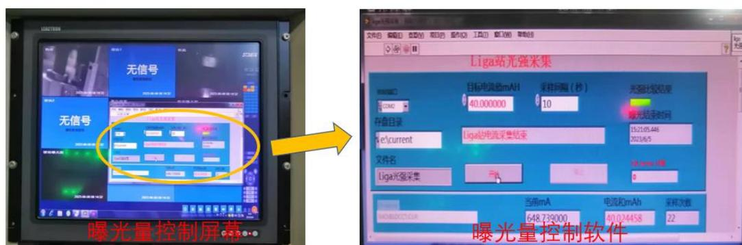
曝光量控制屏幕：主要用于曝光量控制软件的操作，同时用于线站设备的监控等。
