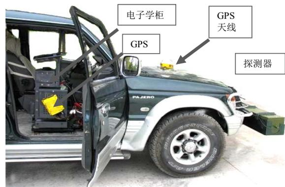
图 12 车载 NaI(Tl) $\gamma$  谱仪系统整体效果
