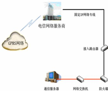
图 2. 核应急数据通信处理中心结构图
