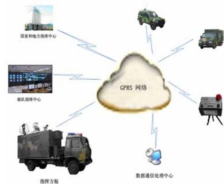
图 1. 核应急指挥控制系统总体结构图
