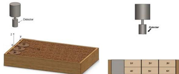
图 13 三维分布不均匀体源检验实验示意图
