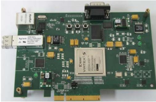
图6. Microblaze软核方案的电路板
