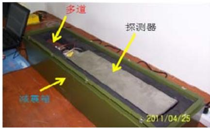
图 8 探测器减震箱
