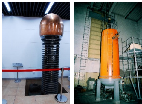
图3 1955年建成的700keV静电加速器(左)和1958年建成的2.5MeV静电加速器(右)
