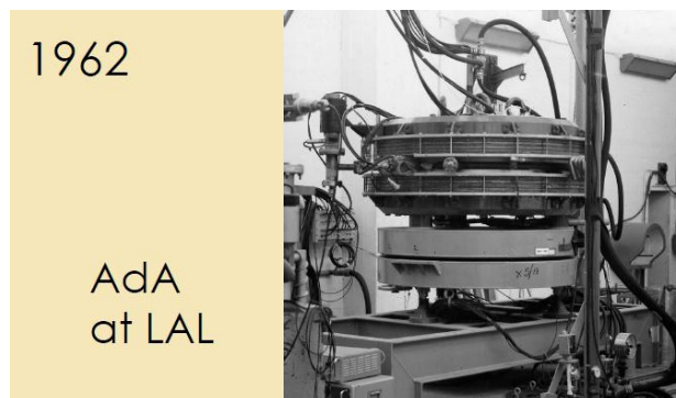
世界上第一台正负电子对撞机 AdA
